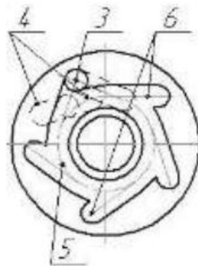
Рисунок 2. - Взаємне розташування пазів півмуфт під час зачеплення (пази ведучої півмуфти наведено пунктирними лініями)
