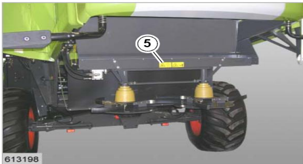
Рис. 2 – Система для розсівання полови (за решітним станом) по полю: два горизонтальні ротатійні диски на вертикальних осях обертання
